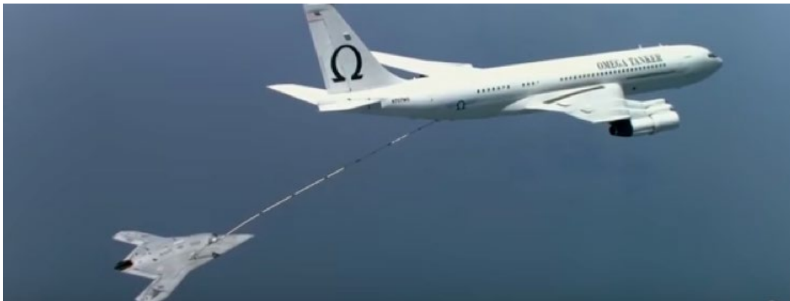
X-47B insansız hava sistemi otonom havada yakıt ikmali testi. 37
